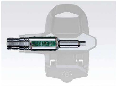
Pédale automatique de vélo qui calcule la puissance de pédalage en mesurant les efforts et la cadence sur chaque pédale grâce à 8 jauges de contraintes qui détectent la déformation de l'axe.
