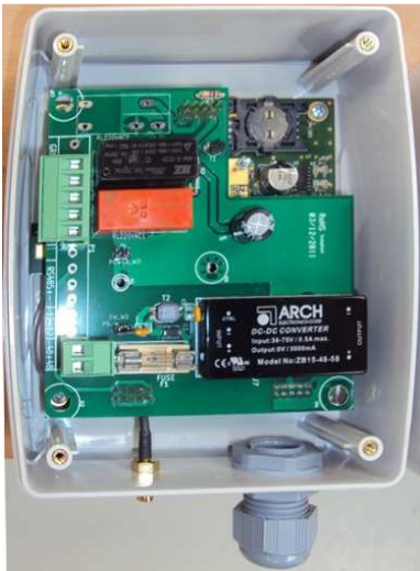
Solution QOWISIO qui permet la supervision et la gestion des sources d'énergie pour les stations télécoms isolées, optimisant ainsi la consommation énergétique des relais de téléphonie mobile. (Société QOWISIO)
