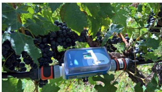
Débitmètre connecté de précision, plug and play pour une meilleure gestion de l'irrigation (société ITK).
