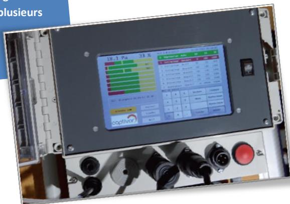
Le système regroupe en un seul appareil les fonctions de mesure, enregistrement, affichage, archivage et transmission à distance des rapports de mesures de la dépression et des alarmes constatées sur les chantiers en zone confinée.
