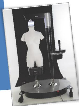
Equipé d'un système de capteurs et d'éclairage pour visualiser les lignes d'aplombs, chaque erreur ou défaut de production est notifié par le logiciel qui contrôle la mesure du vêtement posé sur le buste. Ce logiciel permet le suivi de la conception à la production d'un vêtement par l'édition de fiches techniques qui permettent de suivre l'ensemble des évolutions.
