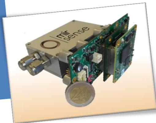
Multisense regroupe, en son sein, deux briques technologiques brevetées et issues de plusieurs années de développement qui lui ont permis d'atteindre la maturité industrielle : des Lasers QCL infrarouge et une cellule photoacoustique. Les Lasers à Cascade Quantique sont l'une des seules technologies permettant de produire une émission dans le moyen-infrarouge (3 $\mu$ m-12 $\mu$ m) à
